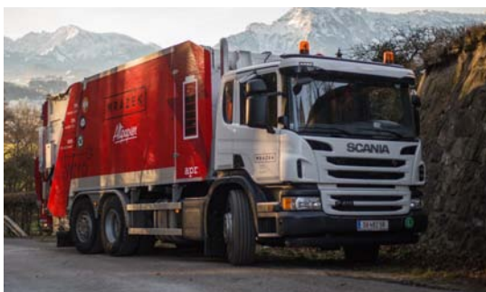
Das neue Altpapier-Sammelfahrzeug bringt durch den Hybrid Aufbau deutlich weniger Lärm beim Be- und Entladen und Papierpressen sowie um ein Viertel weniger Kohlendioxid-Ausstoß und Dieselverbrauch
